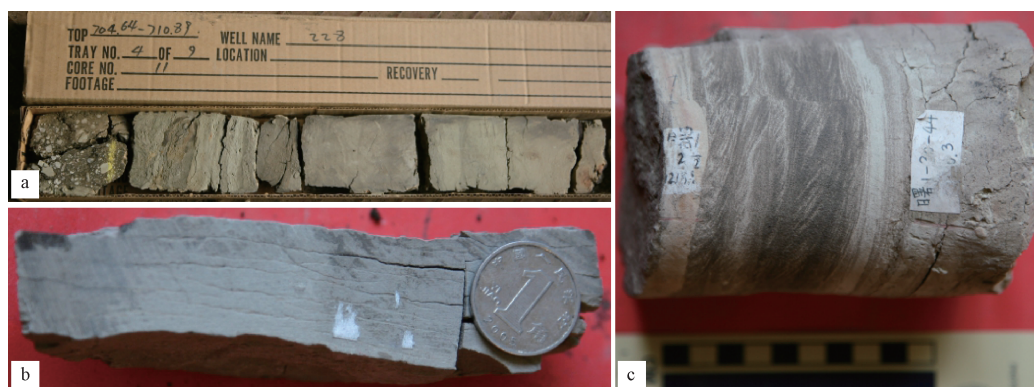
图4 辽河西部凹陷杜84块兴I油层分流间湾处的泥岩
